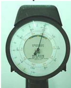
Циферблат прибора для проверки твёрдости по Роквеллу
